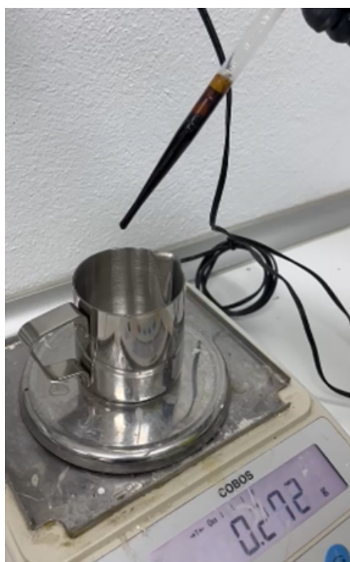
Fotografía 2. Dosificación de BIOROAD en laboratorio
