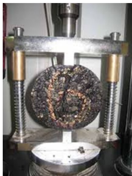
Fotografía 9. Ensayo de tracción indirecta
